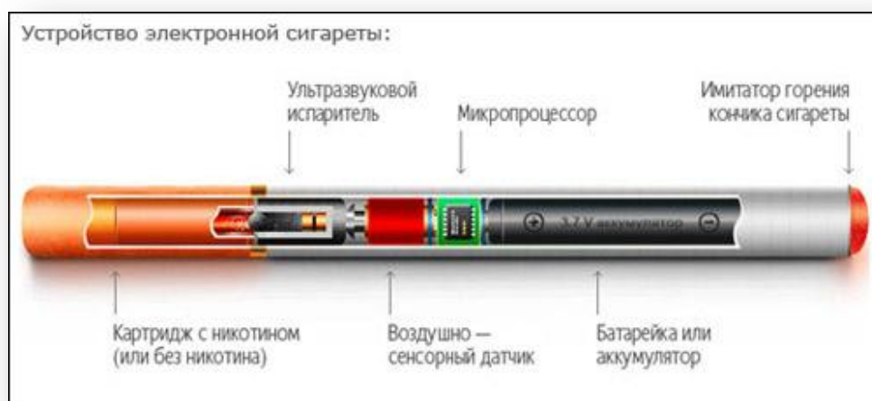
Рис.1 Схема простейшей электронной сигареты
